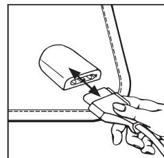
**Verbinden Sie den Schalter erst wieder mit dem Wärme-Unterbett, wenn die Steckkupplung und das Wärme-Unterbett vollständig trocken sind.**
