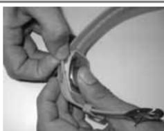
Auf dem Uhrgehäuse befinden sich an der Ober- und Unterkante kleine Einrasthaken (1). Das Armband hat die entsprechenden Schlitze (2).
